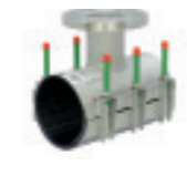
Serie 729/32 Reparationsklamme Dobbeltbånd med flangetilslutning og afstivere Rustfrit stål AISI 304 eller AISI 316 NBR- eller EPDM-gummi
