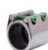
Serie 745/20 Repico Slip kobling Universal og trækfast for alle rørmaterialer Rustfrit stål AISI 316 NBR eller EPDM DN15-600
