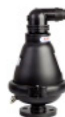
Serie 701/75 Kombinationsudluftningsventil Udluftningsareal: Automatisk: 12 mm 2 Kinetisk: 804 mm 2 Forstærket nylon Indløbsflange eller 2" 3" BSP-gevind DN50-100 PN10
