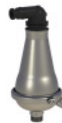
Serie 701/75 Kombinationsudluftningsventil Udluftningsareal: Automatisk: 12 mm 2 Kinetisk: 804 mm 2 Forstærket nylon Indløbsflange eller 2" 3" BSP-gevind DN50-100 PN10
