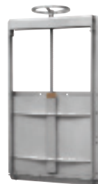
Serie 772/61 Vægmonteret skydespjæld Gennemstrømning fra begge sider til og med 1200 X 1200 mm, i større størrelser fra én eller begge sider Med ikke-stigende spindel Rustfrit stål AISI 304 200 x 200 mm - 2000 x 2000 mm
