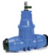
Serie 16/54 Stikledningventil med trækfaste indstiksmuffer til PE-rør PN 16 POM (Polyoxymethylen) DN25-50
