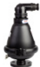
Serie 701/75 Kombinationsudluftningsventil Udluftningsareal: Automatisk: 12 mm 2 Kinetisk: 804 mm 2 Forstærket nylon Indløbsflange eller 2" BSP- gevind DN50-100 PN10
