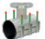
Serie 729/32 Reparationsklamme Dobbeltbånd med flangetilslutning og afstivere Rustfrit stål AISI 304 eller AISI 316 NBR- eller EPDM-gummi
