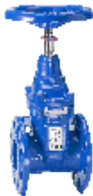
Serie 06/84 Flangeventil Kort byggelængde DIN F4 NBR-skyder Spindel af syrefast stål AISI 316 Duktiljern DN40-1000 Fra DN 450 med ISO-topflange
