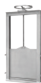
Serie 772/7172 Kanalmonteret skydespjæld Gennemstrømning fra én side til og med 1000 X 1000 mm, i større størrelser fra begge sider Med ikke-stigende spindel Rustfrit stål AISI 304 200 x 200 mm - 2000 x 2000 mm
