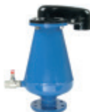
Serie 701/96 Kombinationsudluftningsventil Udluftningsareal: Automatisk: 12 mm 2 Kinetisk: 804 mm 2 Rustfrit stål Indløbsflange eller 2" BSP- gevind DN50-200 PN16
