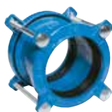
Serie 601 Supa® lige kobling Universal til uPVC-, AC-, stål-, gråjerns- og duktiljernsrør Duktiljern DN 40-400 PN 16
