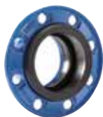
Serie 05 Combi-flange til PVC-rør Ikke trækfast Duktiljern/EPDM DN 50-300 PN 10/16
