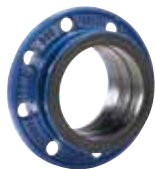
Serie 05 Combi-flange til duktiljernsrør Ikke-trækfast Duktiljern/EPDM DN 50-300 PN 10/16
