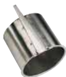
Serie 05 Støttebøsning til PE-rør Velegnet til Supa Maxi™, Supa Plus™ og combi- flanger Rustfrit stål DN 50-400 PN 10/16 SDR 11/17
