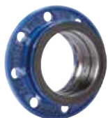
Serie 05 Combi-flange til duktiljernsrør Trækfast Duktiljern/EPDM DN 50-300 PN 10/16
