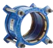
Serie 621/10 Supa Plus™ lige kobling Trækfast til PE- og uPVC-rør Duktiljern DN 32-300 PN 16
