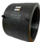
Serie 1200/00 Svejsemuffe PE100 SDR11-26: Vand PN16/Gas 10 bar SDR17-26: Vand PN10/Gas 6 bar ø355-400
