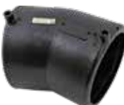
Serie 1203/21 Svejsebøjning 22.5° PE100 Vand PN16/Gas 10 bar ø180
