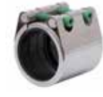
Serie 745/20 Repico® "Slip"-kobling Universal og ikke- trækfast til alle rørtyper NBR- eller EPDM- pakning DN15-600 Rustfrit stål AISI 316
