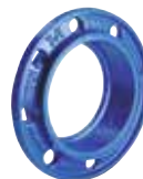
Serie 05 Combi-flange til uPVC-, stål- og duktiljernsrør Ikke-trækfast DN400-600 (uPVC og duktil) DN50-300 (stål) PN10/16 Duktiljern
