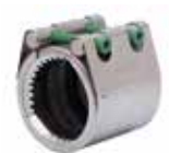
Serie 745/01 Repico® "Grip"-kobling Universal og trækfast til alle metalrør NBR- eller EPDM- pakning DN15-400 Rustfrit stål AISI 316
