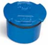
Prop udført i GG-25, epoxybelagt efter DIN 30677. Monteret med NBR O-ring.
