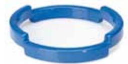
15 mm afstandsring i GGG-40 epoxybelagt efter DIN 30677. Til justering af dækselhøjde.
